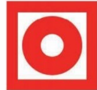
«Кнопка включения установок пожарной автоматики»
